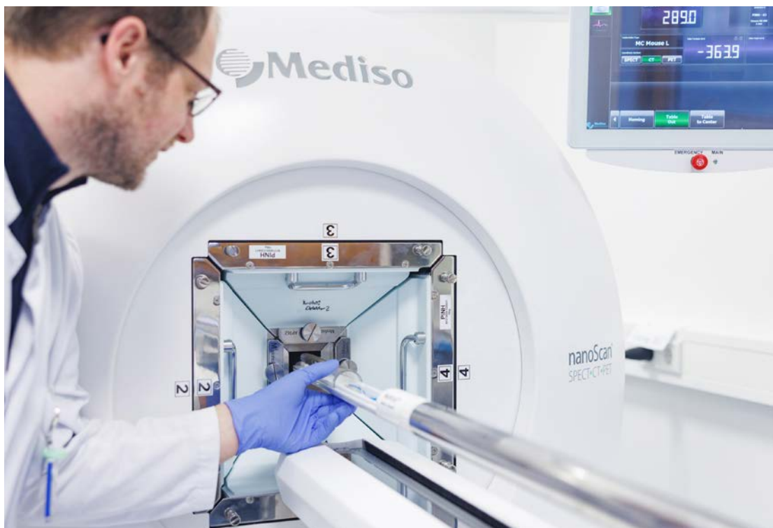
Für die präklinische Forschung geht gerade ein neuartiges „Triple-Hybrides“ Kleintier-PET/CT-Gerät mit SPECT-fähiger Gammakamera in Betrieb. Hiermit können interessante Shuttlemoleküle vorab im Tiermodell getestet werden, bevor diese in einem nächsten Schritt beim Menschen angewandt werden. Der Leiter der präklinischen Bildgebung Nils Schupp platziert eine Testprobe, die dann in das Gerät eingeführt wird.
