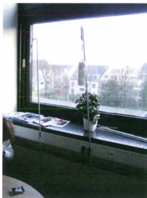
Foto 4.2: Vergleichsmessung mit zwei unterschiedlichen Adsorbentmedien; linke Pumpe mit Florisil-Röhrchen und rechte Pumpe mit PU-Schaum befüllte Glaskartusche
